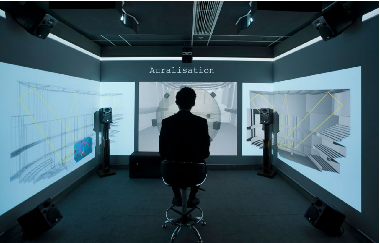
奥雅纳声音实验室采用3D Ambisonics 声音系统，让客户和设计师能够聆听 3D 模拟声源。
